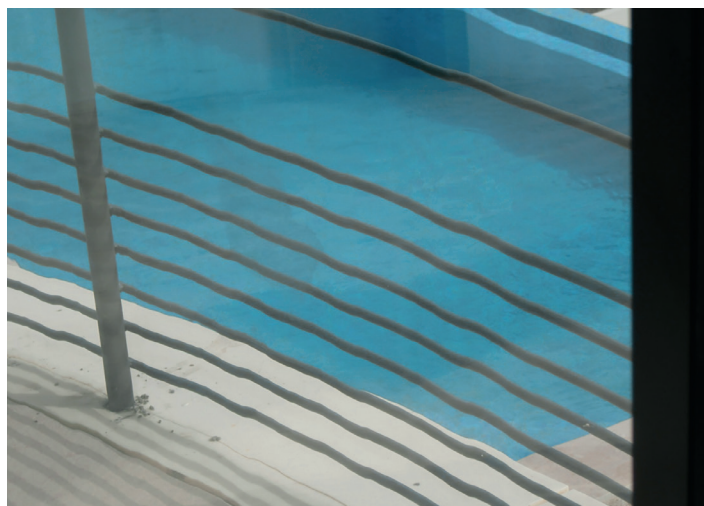
Illustration 19 : déformation de l'image extérieure créée par des variations de planéité ou d'épaisseur.
